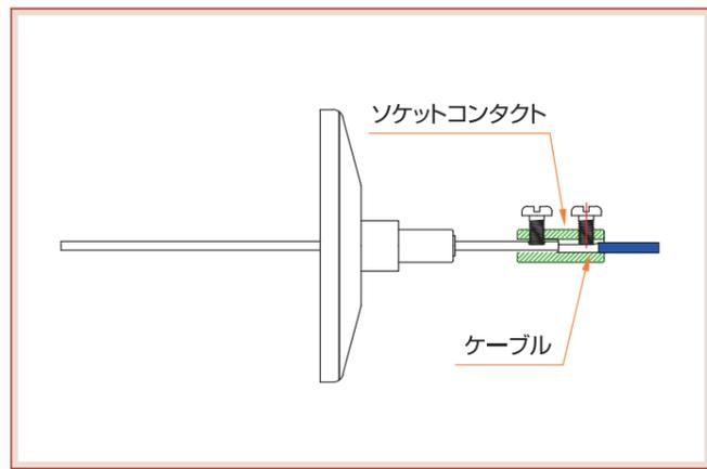
※Section 4.1 & 4.4 の真空側に限り、ネジ切りを切断し、ソケットコンタクトを使用する事が可能です。
